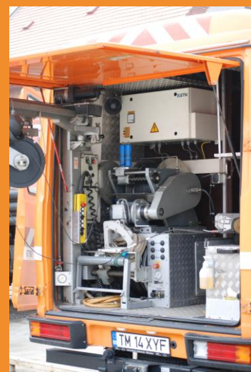
Autolaborator dotat cu echipamente pentru inspecția video a rețelelor de canal (CCTV)
